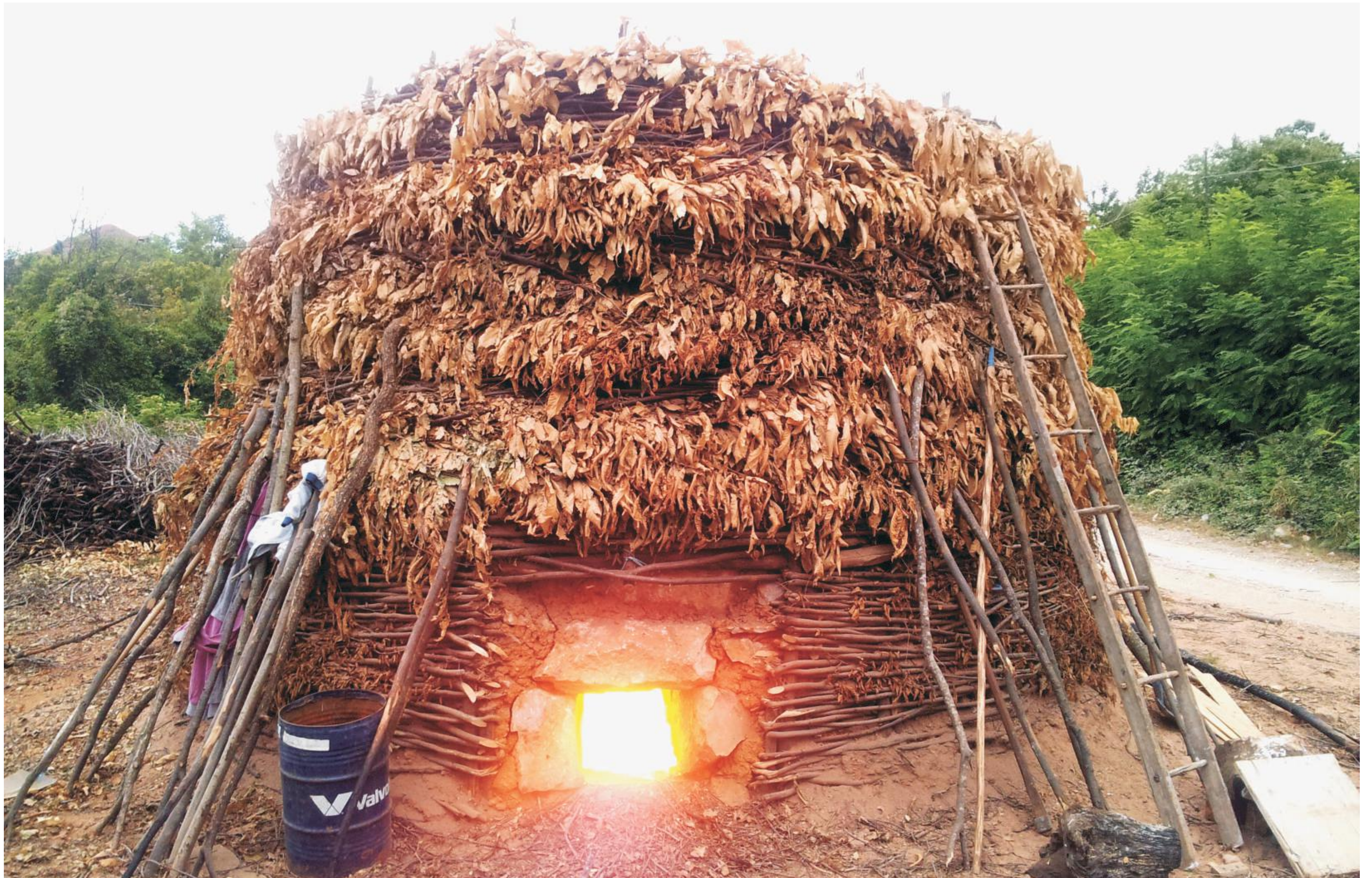
Gëlqerja, guri, dheu, druri dhe zavorri janë materialet bazike tradicionale. Ato ende gjenden në këtë trevë. Në foto lartë shihet një furrë gëlqereje e ndërtuar në fshatin Mulliq, 5 km larg Junikut. Lime, stone, clay, wood and grit are the traditional raw materials. Those are still present in this area. The photo above shows a limekiln built in Mulliq village, 5 km away from Junik.
